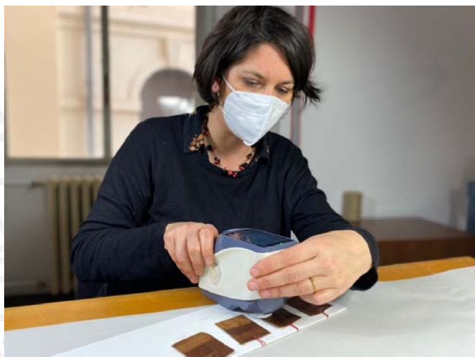
Figura 1 Misure colorimetriche effettuate prima e dopo l'applicazione dei Nasier Gel su campioni preparati in laboratorio
