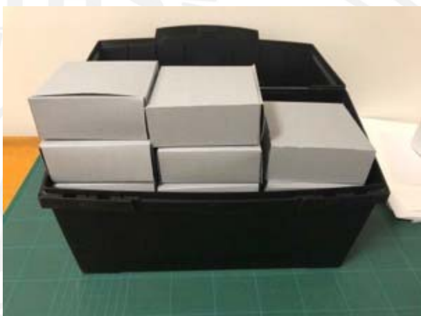
Condizionamento dei microfilm all'interno di custodie in polipropilene 100%, totalmente inerte, ideali per il trasporto e la conservazione a lungo termine
