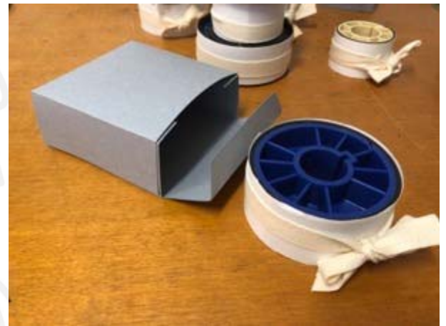
Realizzazione di nuovi contenitori in cartoncino per la conservazione Klug NOMI 330g/mq 100% alfa-cellulosa, acid free, pH 8,5-9,5 con riserva alcalina > 4% di carbonato di calcio
